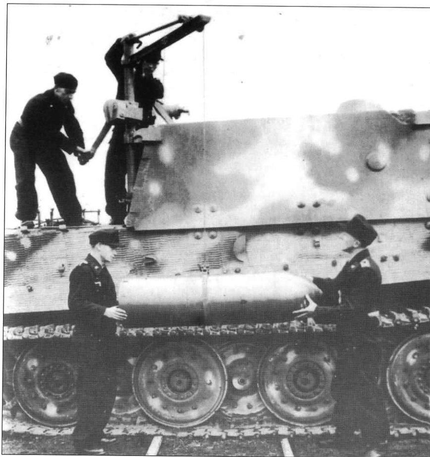
Załoga Sturmtigera podnosi pocisk przy pomocy dźwigu. Crew of Sturmtiger is lifting the ammunition using the crane.
