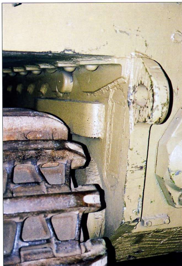
Gąsienice typu Kgs 63/725/130. Na prawym zdjęciu dobrze widoczny odbojnik szpilek gąsienicy. Track type Kgs 63/725/130. On the right photo track pin guide.
