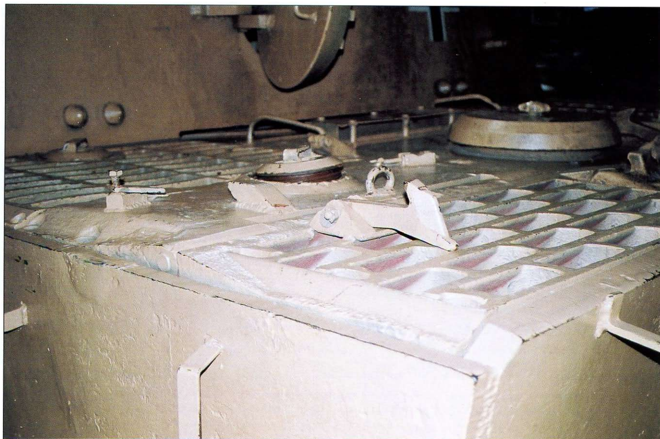
Górna płyta silnikowa — widok z lewej strony. Widoczny kapsel osłaniający wlew paliwa. Upper engine compartment plate — view from the left side. Visible is cover for fuel tank valve.
