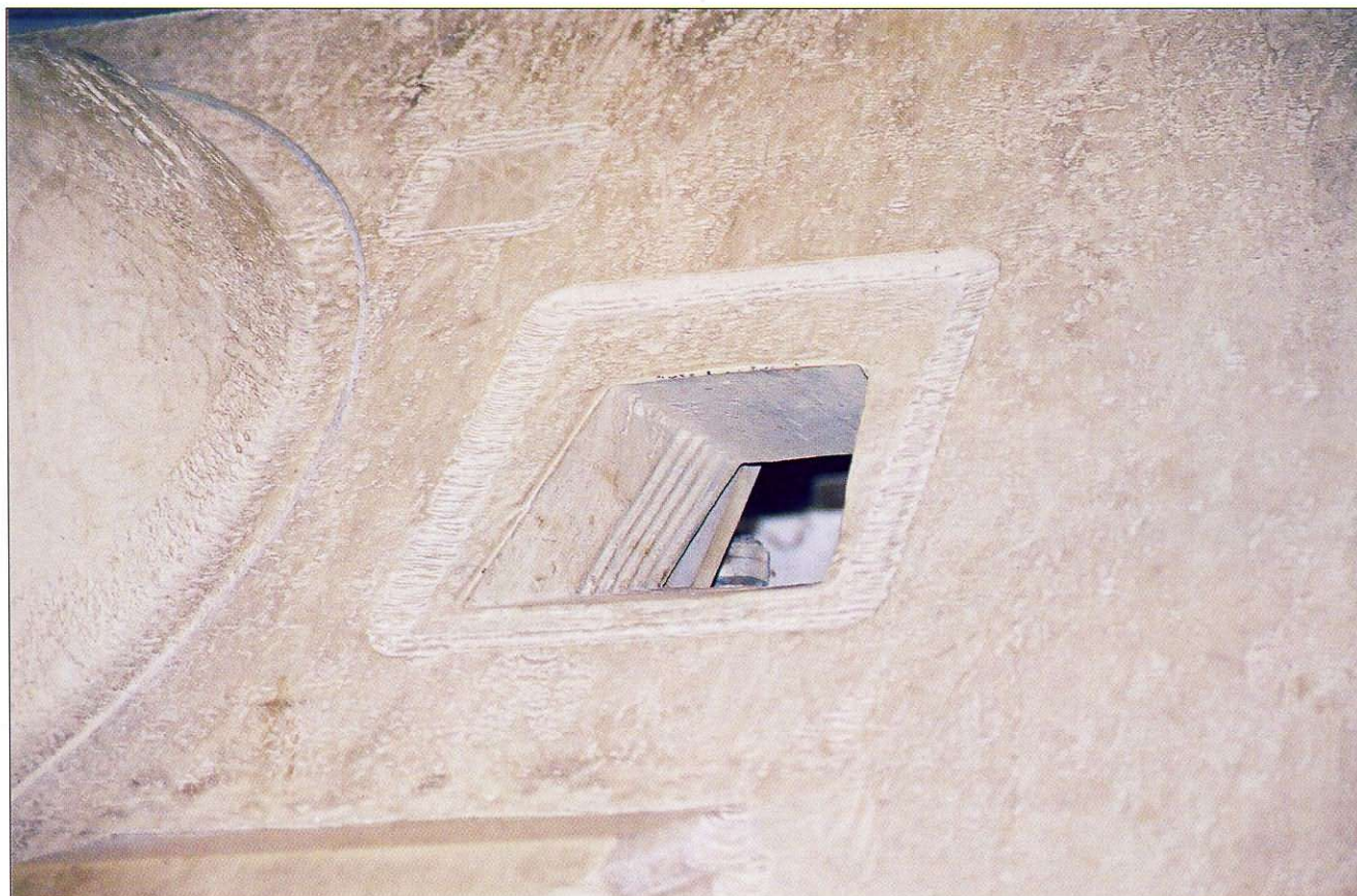
Płyta przednia 150 mm pancerza z dobrze widocznym otworem na dalmierz PaK Zielfernrohr 3 x 8 i peryskopem kierowcy. Frontal plate (150mm thick) with well visible opening for PaK Zielfernrohr 3 x 8 gun sight and driver's periscope.
