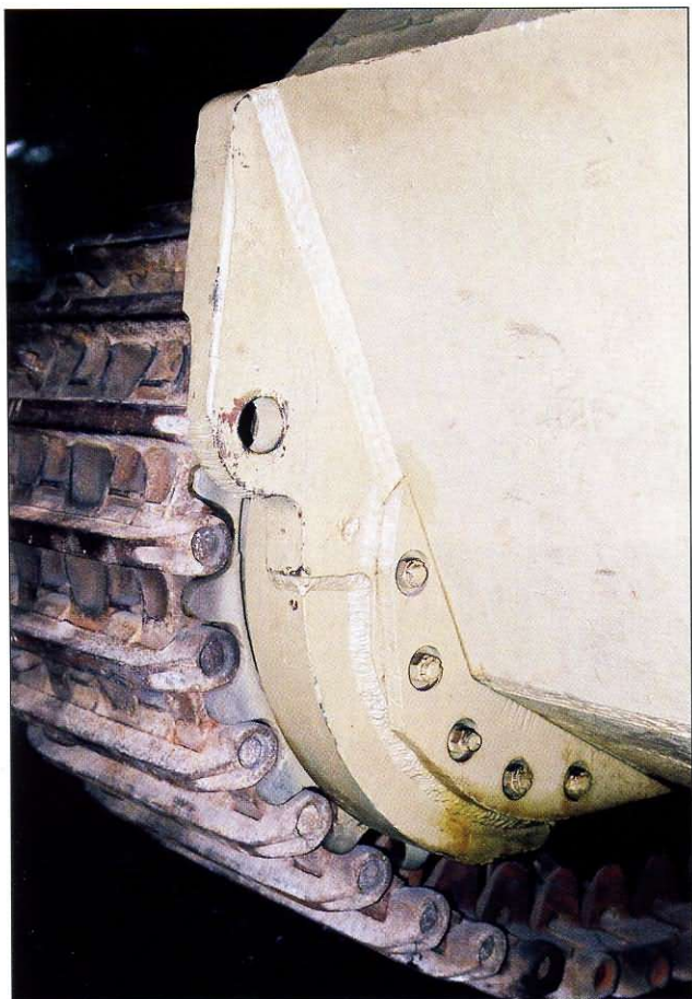
Układ jezdny pojazdu — dobrze widoczne szczegóły osłony przekładni i wewnętrzna strona koła napinającego. Suspension with visible covers for mechanical parts and inside of the idler wheel.
