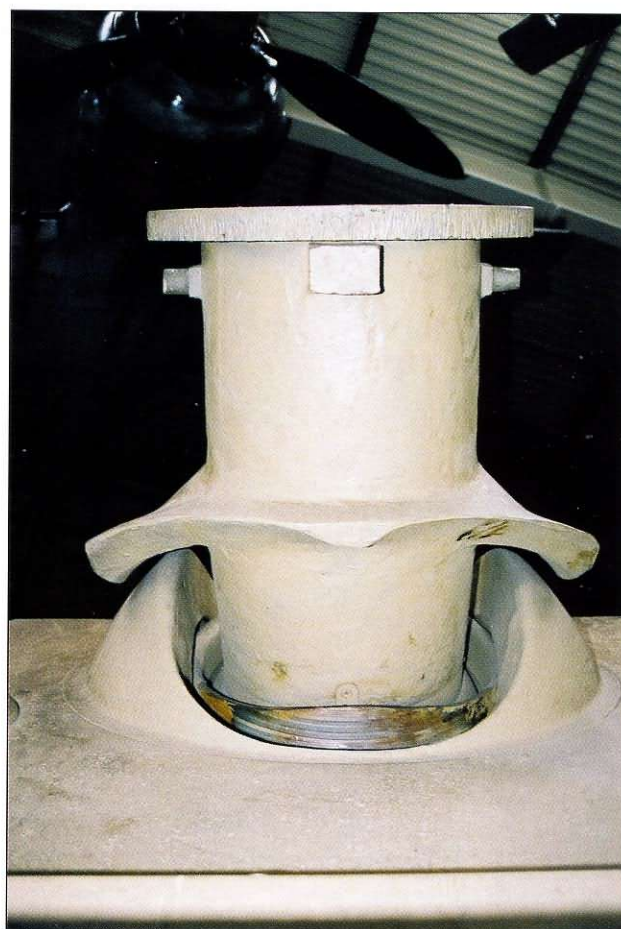
Lufa moździerza RW 61 — dobrze widoczne jarzmo, gwint oraz kanały odprowadzające gazy prochowe odpalanych pocisków. Barrel of RW 61 launcher with mantlet, rifled barrel and ventilation shafts.
