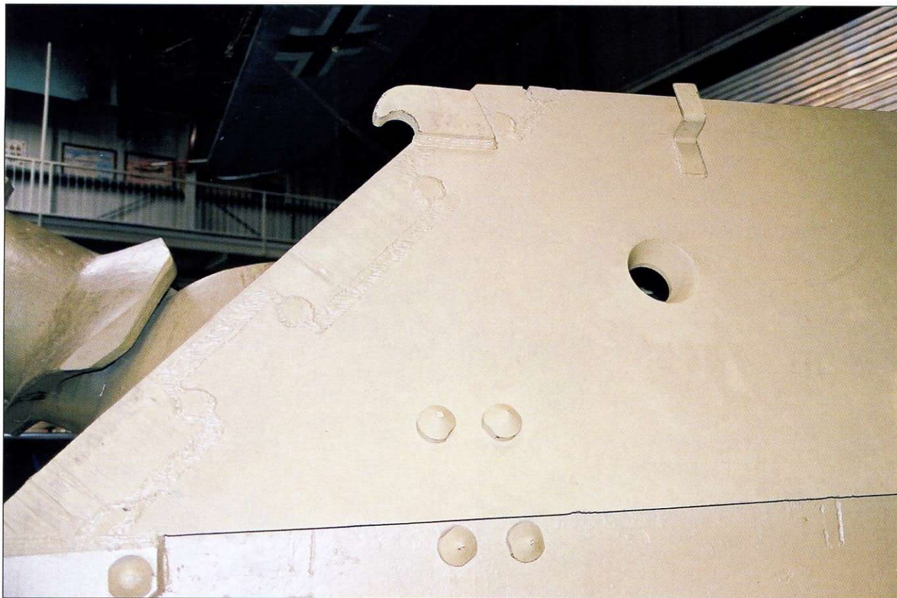
Lewa płyta przedziału bojowego. Uwagę zwracają stożkowe łby śrub łączących nadbudówkę z kadłubem, hak do zdejmowania nadbudówki oraz otwór strzelniczy dla pistoletu MP.
