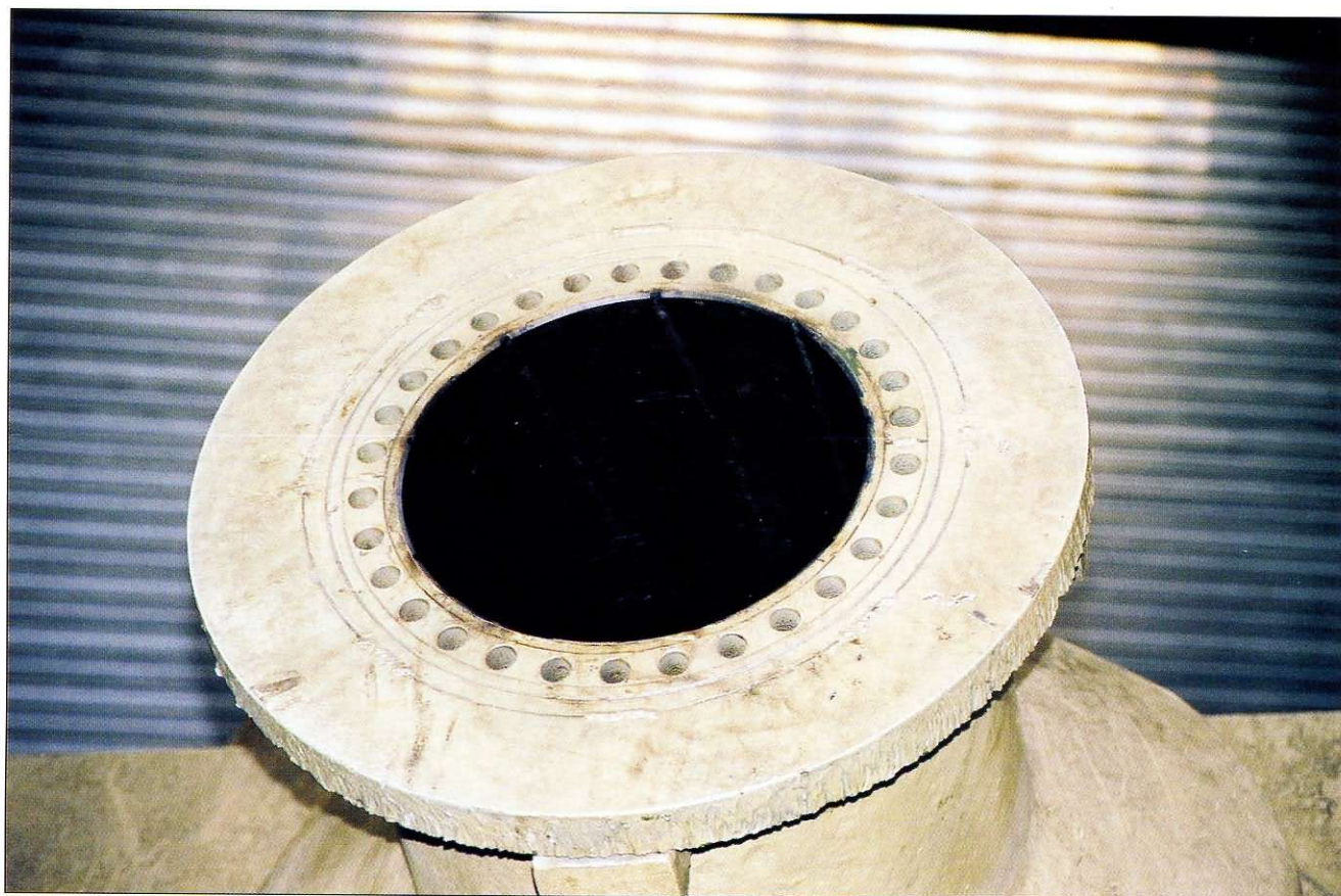
Lufa moździerza RW 61 — dobrze widoczne jarzmo, gwint oraz kanały odprowadzające gazy prochowe odpalanych pocisków. Barrel of RW 61 launcher with mantlet, rifled barrel and ventilation shafts.
