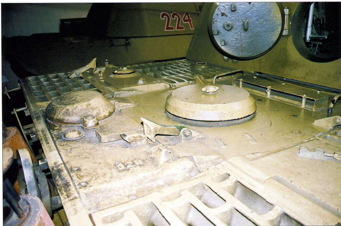
Górna płyta silnikowa — widok z prawej strony. Dobrze widoczne osłony wentylatorów oraz pancerne osłony wylotów powietrza.
