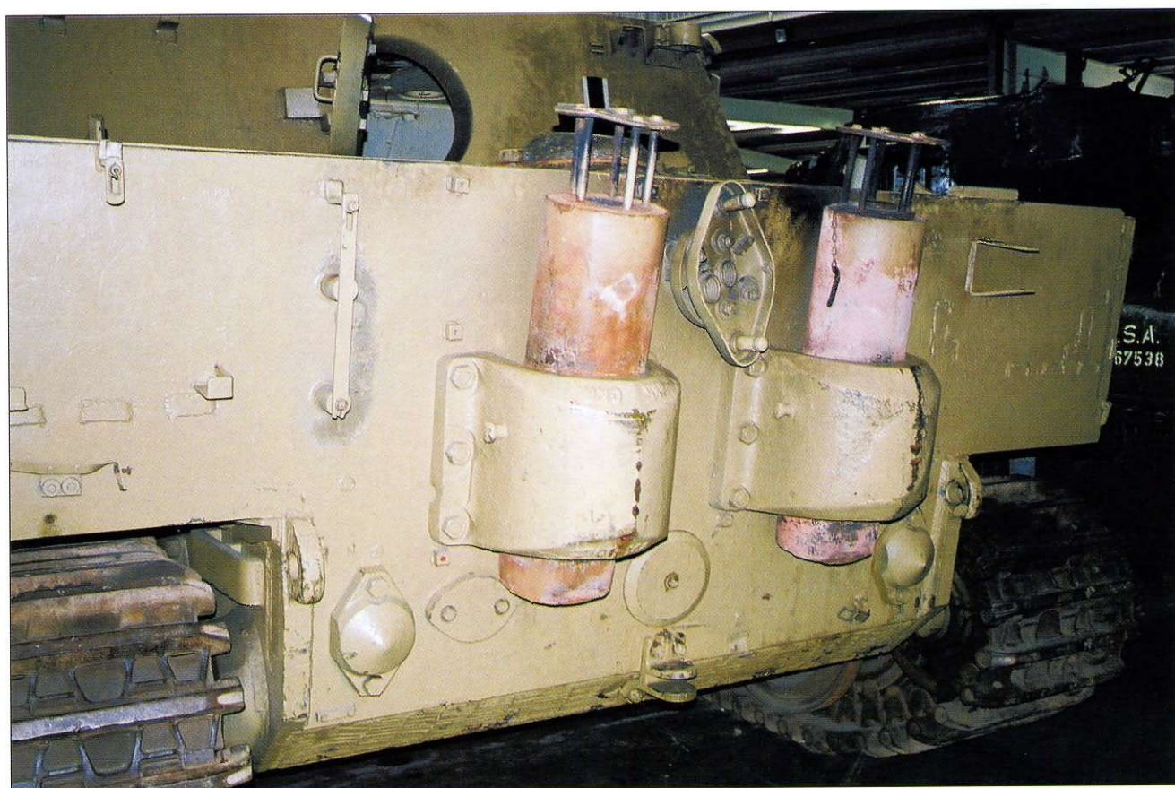
Rury wydechowe — dobrze widoczne pancerne, odlewane osłony kolektorów spalin. Exhaust pipes — visible are cast armored muffler covers.
