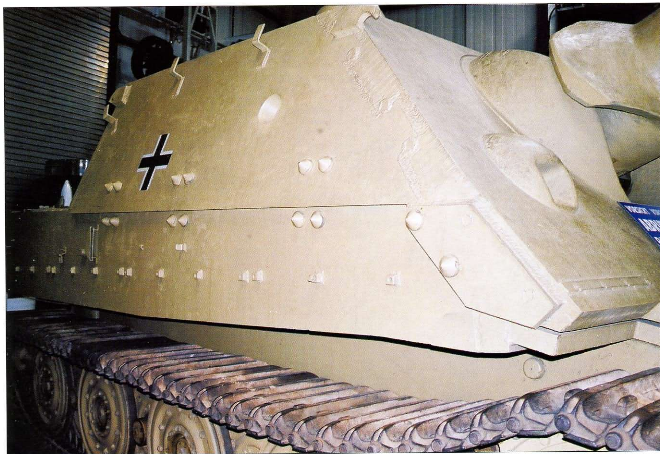
Szczegóły łączenia płyt przedziału bojowego. Details of joints between fighting compartment plates.
