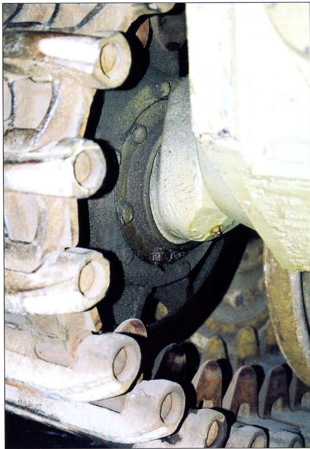
Układ jezdny pojazdu — dobrze widoczne szczegóły osłony przekładni i wewnętrzna strona koła napinającego. Suspension with visible covers for mechanical parts and inside of the idler wheel.
