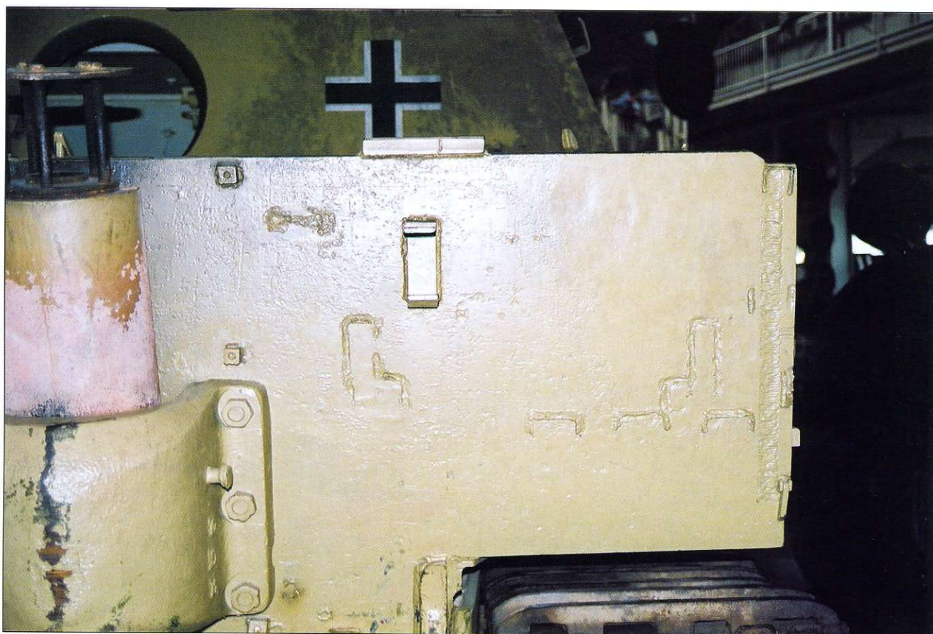
Lewa i prawa strona tylnej płyty silnikowej z widocznymi uchwytami na wyposażenie zewnętrzne. Z prawej strony mocowano podnośnik, z lewej szkiele i drewniany klocek pod podnośnik. Left and right side of the engine compartment plate with mounts for additional equipment. On the right side was jack and on the left side hooks and wooden base for jack.
