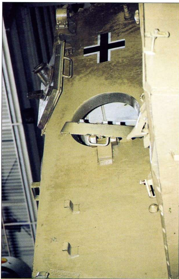
Właz ewakuacyjny w tylnej ścianie nadbudówki. Na tylnej ścianie nadbudówki widoczne uchwyty na zapasowe ogniwa gąsienicy. Escape hatch in the rear wall of the superstructure. Visible are mounts for additional track links.
