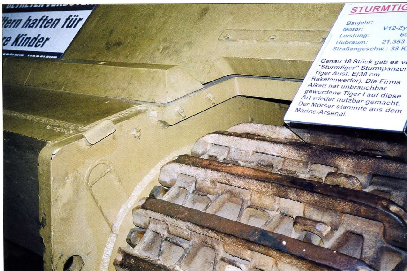
Gąsienice typu Kgs 63/725/130. Na prawym zdjęciu dobrze widoczny odbojnik szpilek gąsienicy. Track type Kgs 63/725/130. On the right photo track pin guide.
