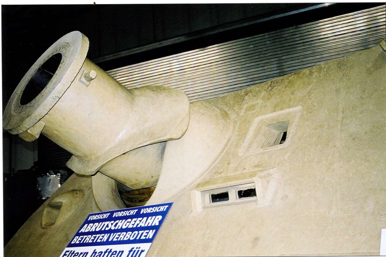
Moździerz 380 mm Raketenwerfer 61. Uwagę zwraca kołnierz wyważający lufę oraz uchwyty służące do demontażu moździerza.
