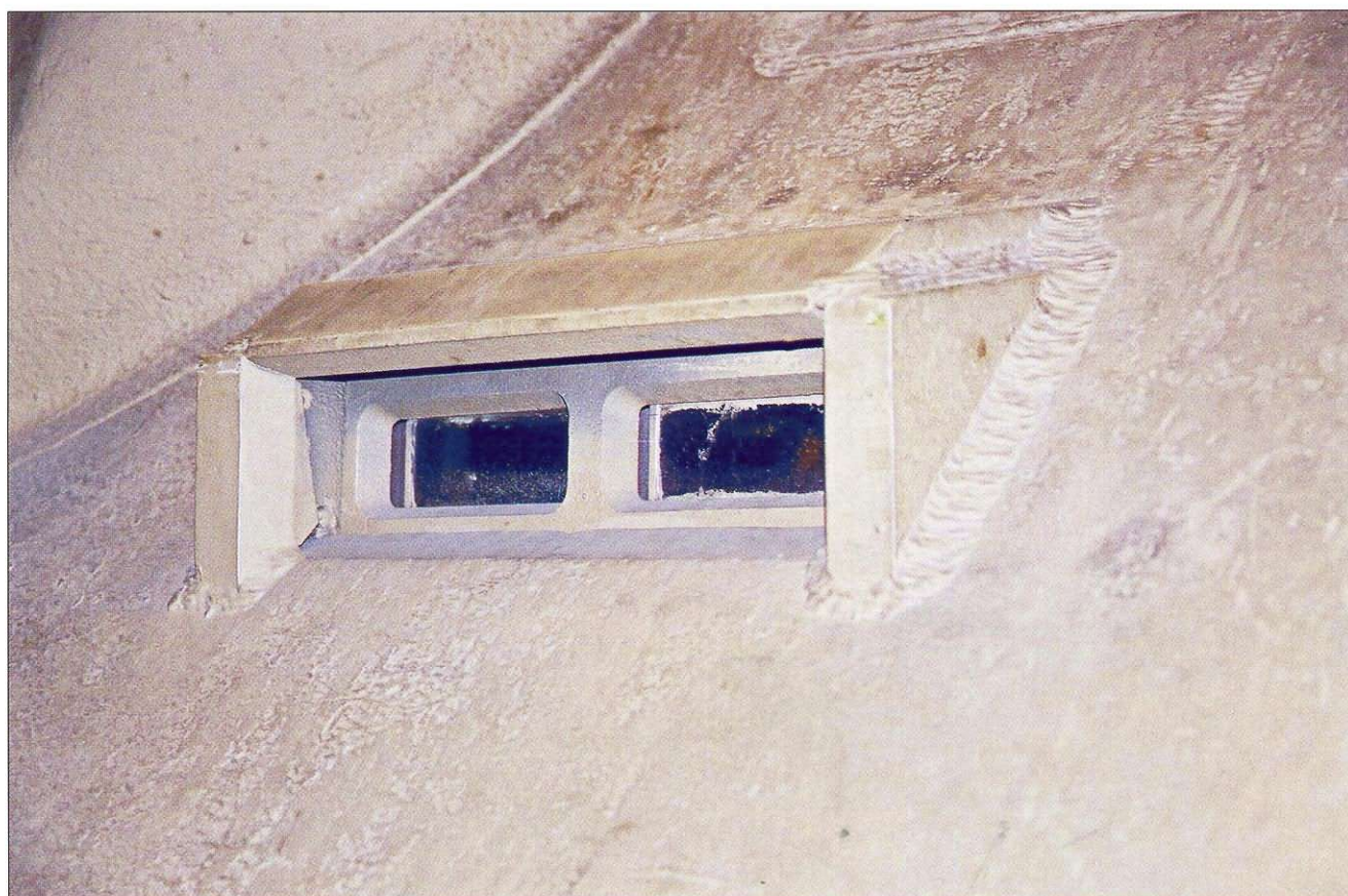
Płyta przednia 150 mm pancerza z dobrze widocznym otworem na dalmierz PaK Zielfernrohr 3 x 8 i peryskopem kierowcy. Frontal plate (150mm thick) with well visible opening for PaK Zielfernrohr 3 x 8 gun sight and driver's periscope.
