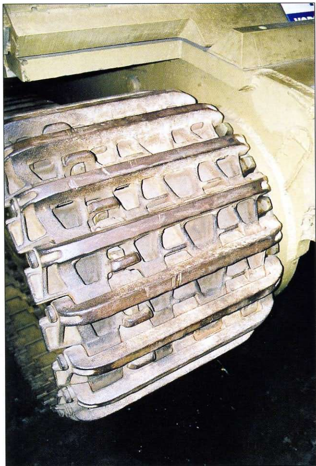
Gąsienice typu Kgs 63/725/130. Na prawym zdjęciu dobrze widoczny odbojnik szpilek gąsienicy. Track type Kgs 63/725/130. On the right photo track pin guide.
