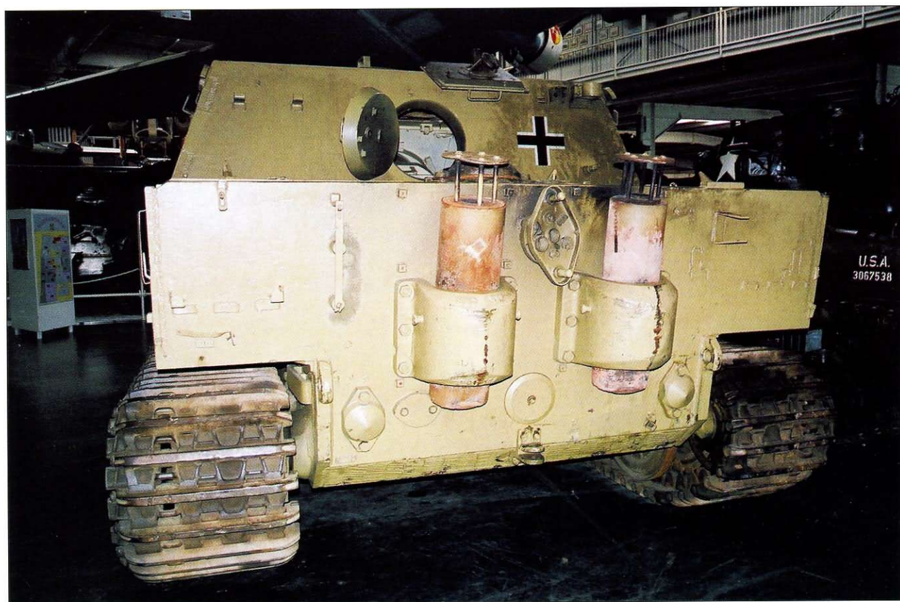
Tylna płyta przedziału silnikowego (grubość pancerza 80 mm) z dobrze widocznym sprzęgłem rozrusznika bezwładnościowego. Rear engine compartment plate (80mm thick) with visible clutch for manual starter.
