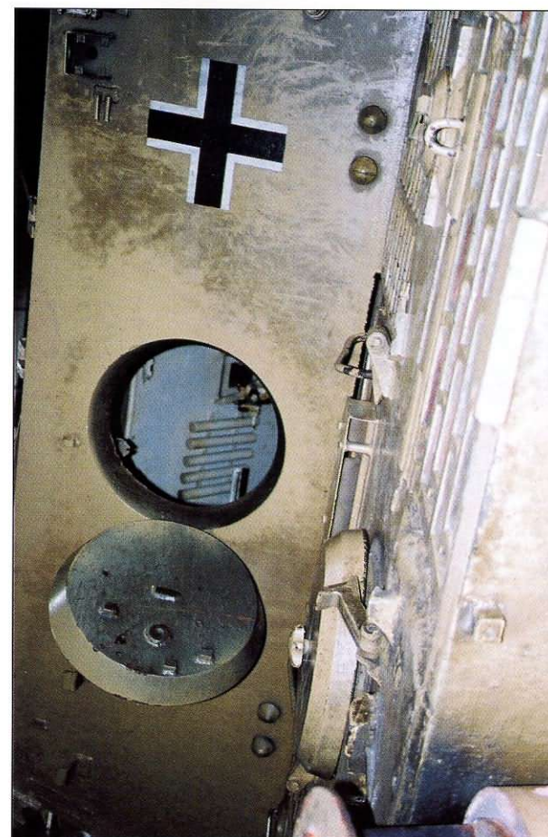
Właz ewakuacyjny w tylnej ścianie nadbudówki. Na tylnej ścianie nadbudówki widoczne uchwyty na zapasowe ogniwa gąsienicy. Escape hatch in the rear wall of the superstructure. Visible are mounts for additional track links.
