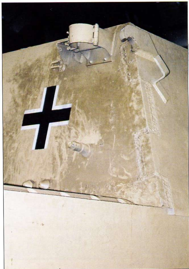
Szczegóły łączenia płyt przedziału bojowego. Details of joints between fighting compartment plates.
