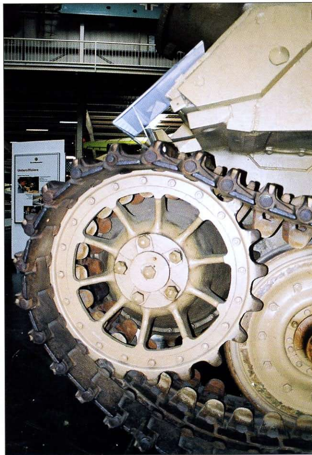
Układ jezdny pojazdu — dobrze widoczne szczegóły osłony przekładni i wewnętrzna strona koła napinającego. Suspension with visible covers for mechanical parts and inside of the idler wheel.
