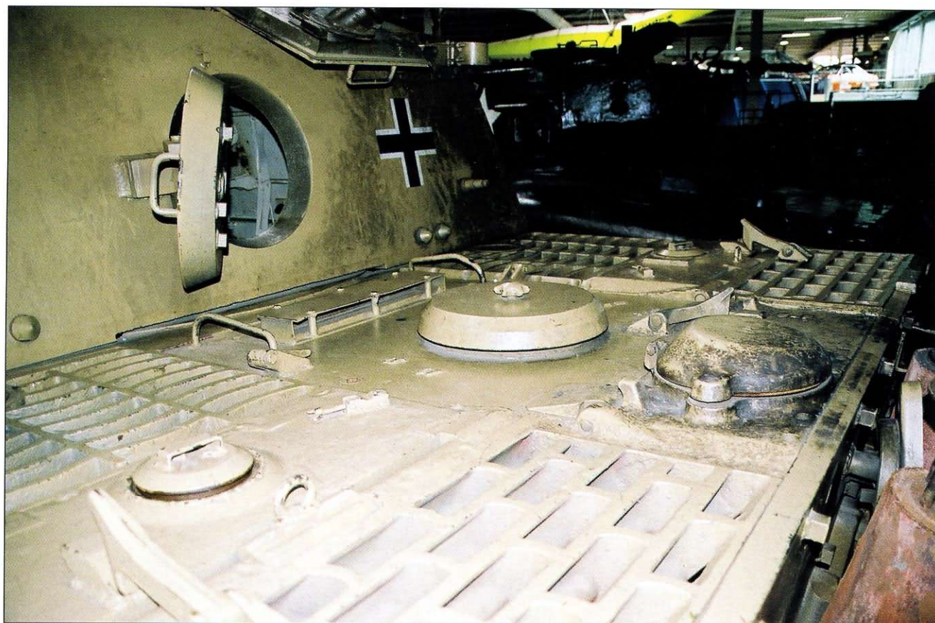
Górna płyta silnikowa — widok z lewej strony. Widoczny kapsel osłaniający wlew paliwa. Upper engine compartment plate — view from the left side. Visible is cover for fuel tank valve.
