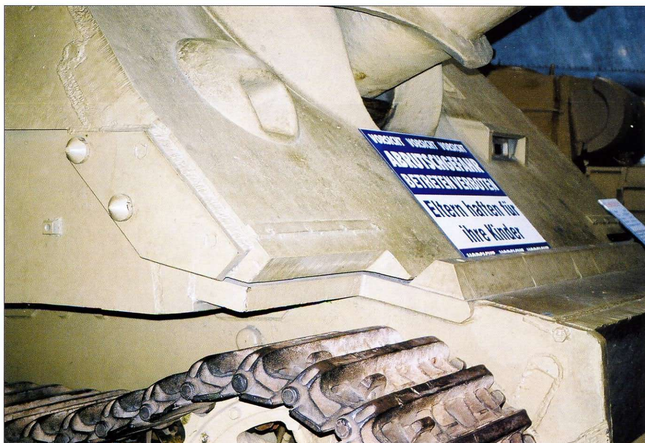
Oslona jarzma karabinu MG 34. Widok z przodu i z prawej strony. MG 34 machine gun mantlet. Front and right side view.
