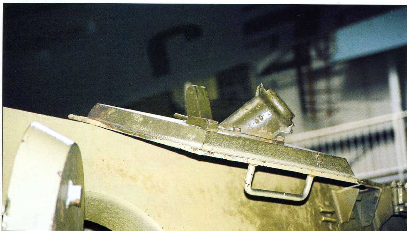
Prawa strona tylnej płyty nadbudówki z otwartą klapą wjazdu, przez którą ładowano pociski rakietowe moździerz.
