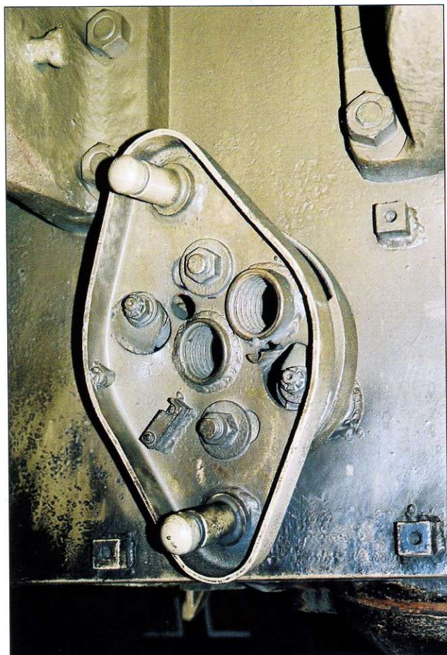
Tylna płyta przedziału silnikowego (grubość pancerza 80 mm) z dobrze widocznym sprzęgłem rozrusznika bezwładnościowego. Rear engine compartment plate (80mm thick) with visible clutch for manual starter.
